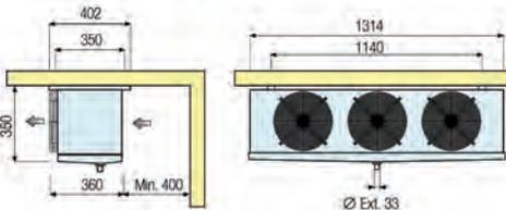
**BT** En los equipos BT la válvula de expansión es del tipo MOP, Tr (máx.) = -10°C.
