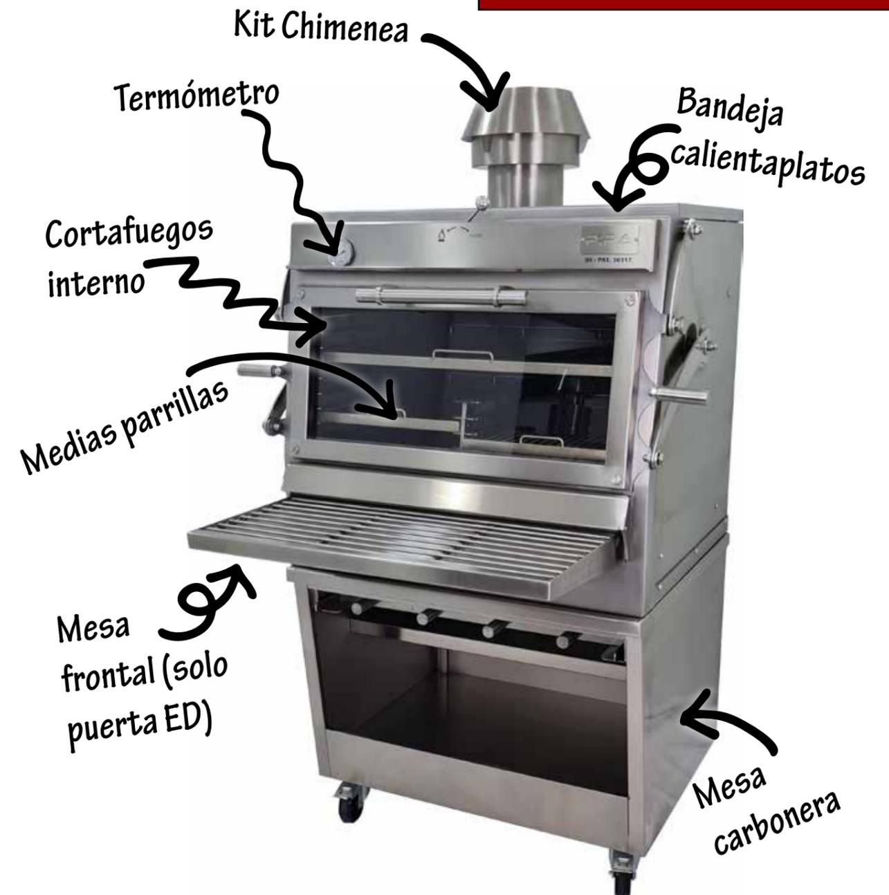
**Características:** Temperatura de trabajo de 180 °C a 350 °C, cortafuegos interno, cajón recoge-ceniza, cajón recoge-grasa (excepto modelos 50), opción de medias parrillas (excepto modelos 50, 70 y 70 XL), salida de humos de 180 mm (modelos 50, 70, 70 XL, 80, 80 XXL, 90 y 90 D) o 210 mm (modelos 120 y 120 D), termómetro, interior en hierro fundido, sistema PiraCold, regulador de tiro integrado.
