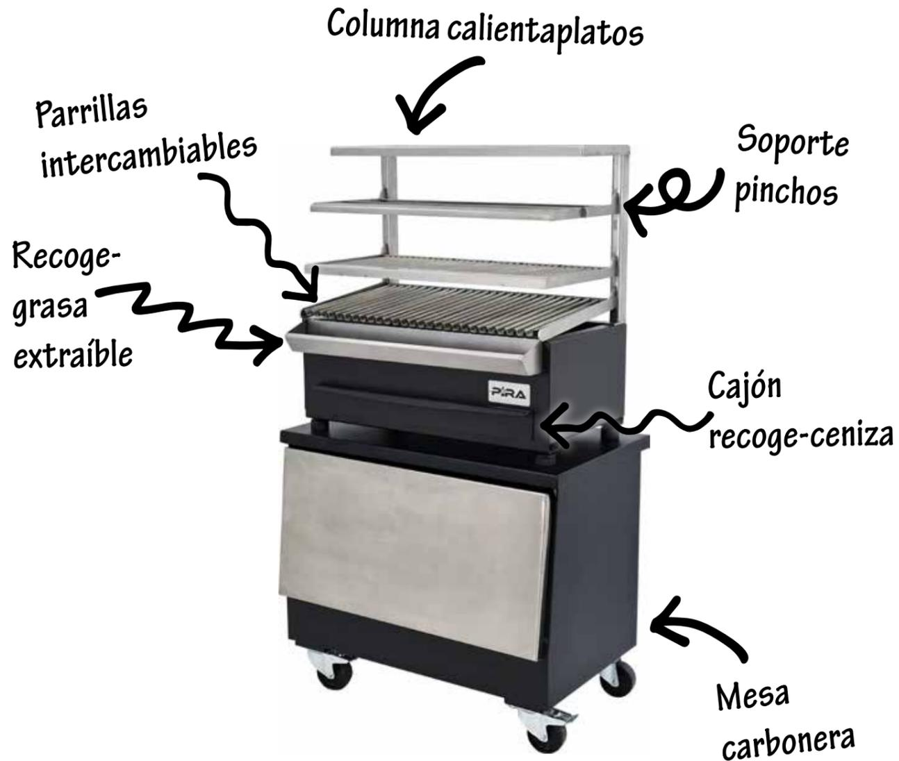
**Características:** Interior en ladrillo refractario, tolva fundición de hierro, columna con 5 posiciones, estante superior fijo calentaplatos, cajón recoge-grasas extraíble, cajón recogedor de cenizas, pies de metal, tiempo de encendido de 30 minutos, temperatura de trabajo de 180 °C a 350 °C.
